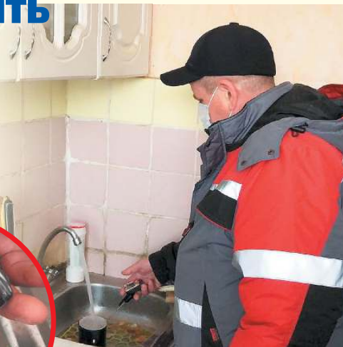
Специалист теплоснабжающей организации провел замеры температуры горячей воды в доме №50 по пр-ту Созидателей
