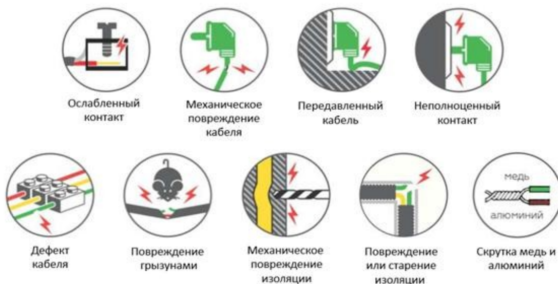
Рисунок 6. Возможные причины искрения в электропроводке
